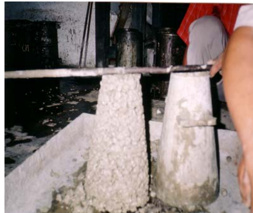
Gambar 2. Hasil Pengujian Slam beton segar Beton non-pasir selalu = 0
